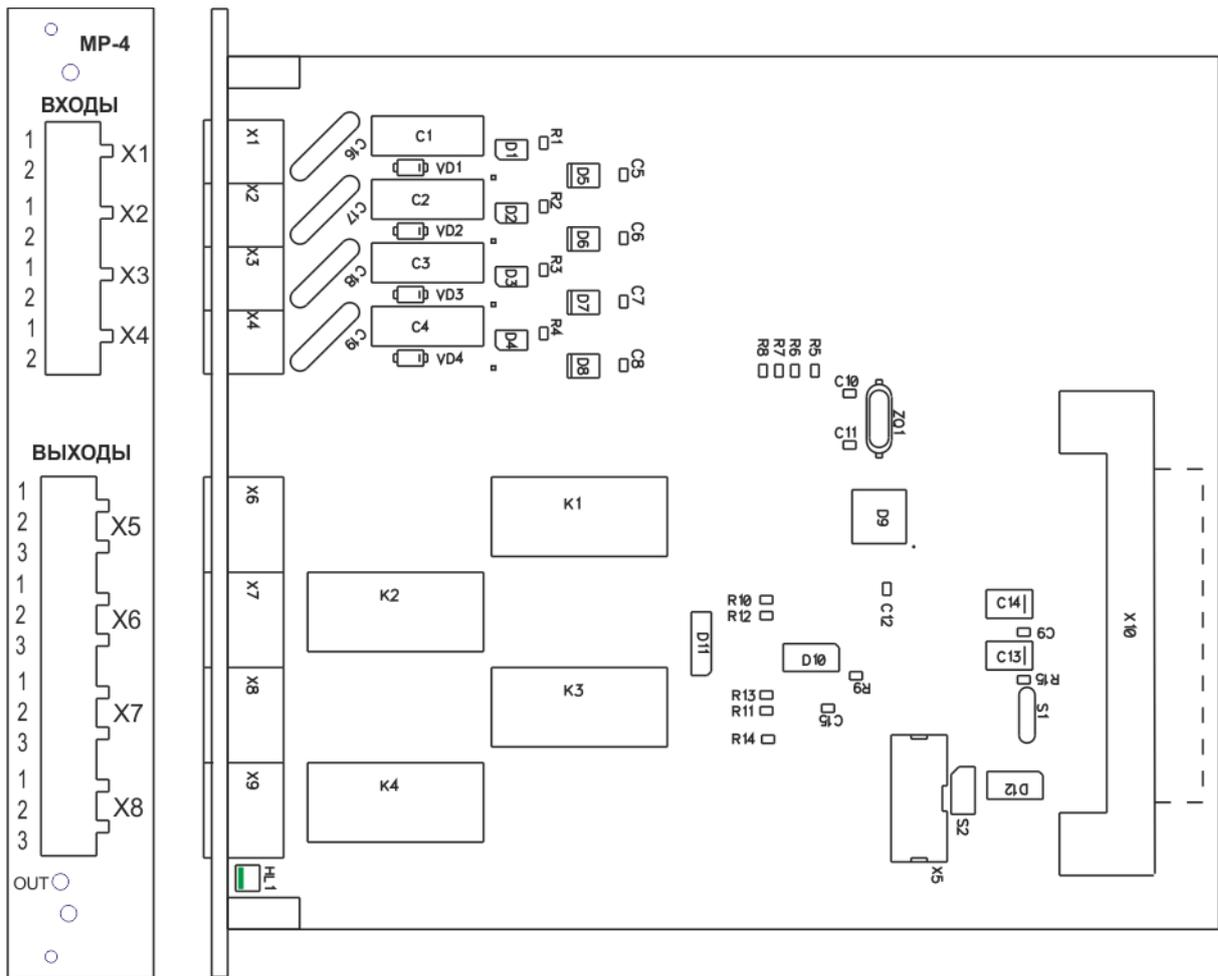
Рисунок 4.10 – Плата модуля реле MP-4
