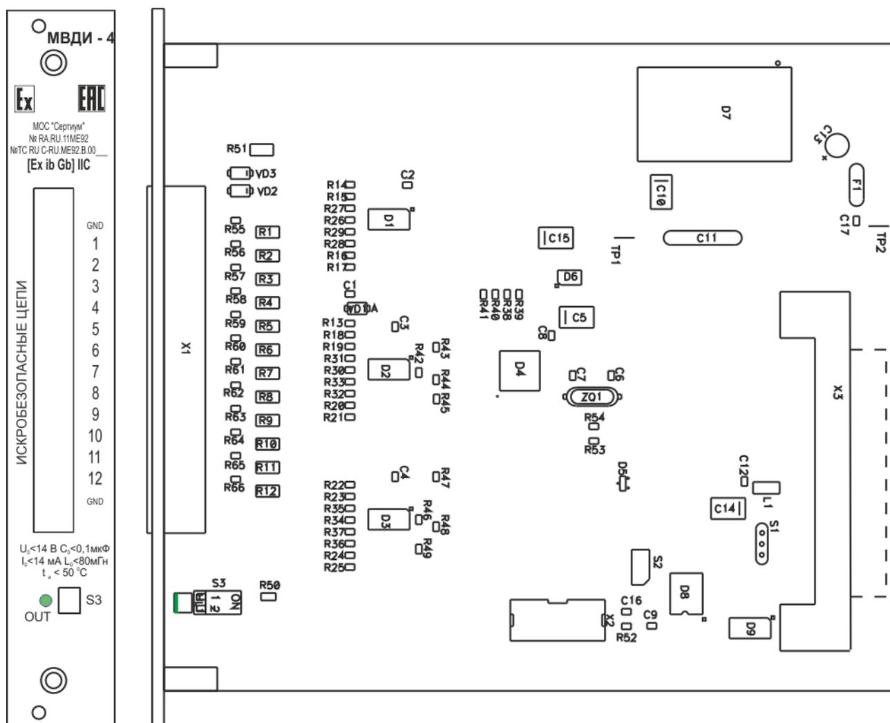
Рисунок 4.6 – Плата модуля ввода МВДИ-4
