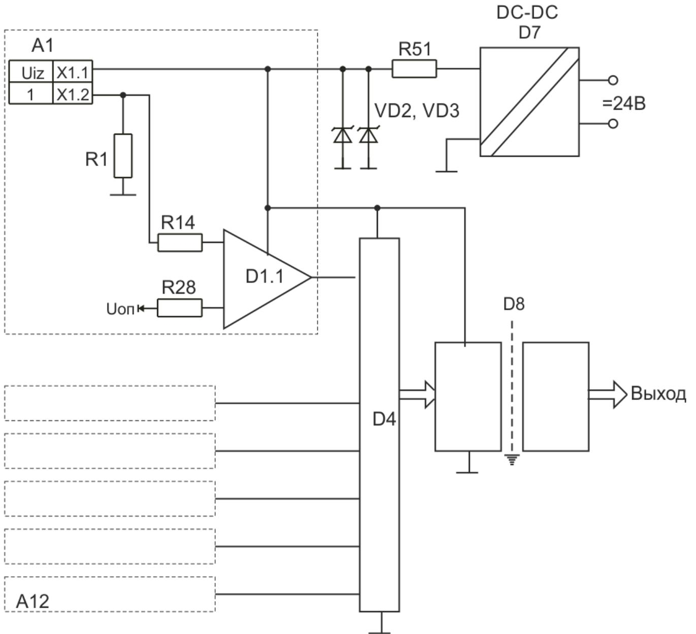
Рисунок 5.1 – Схема узлов, обеспечивающих искробезопасность цепей МВДИ-4
