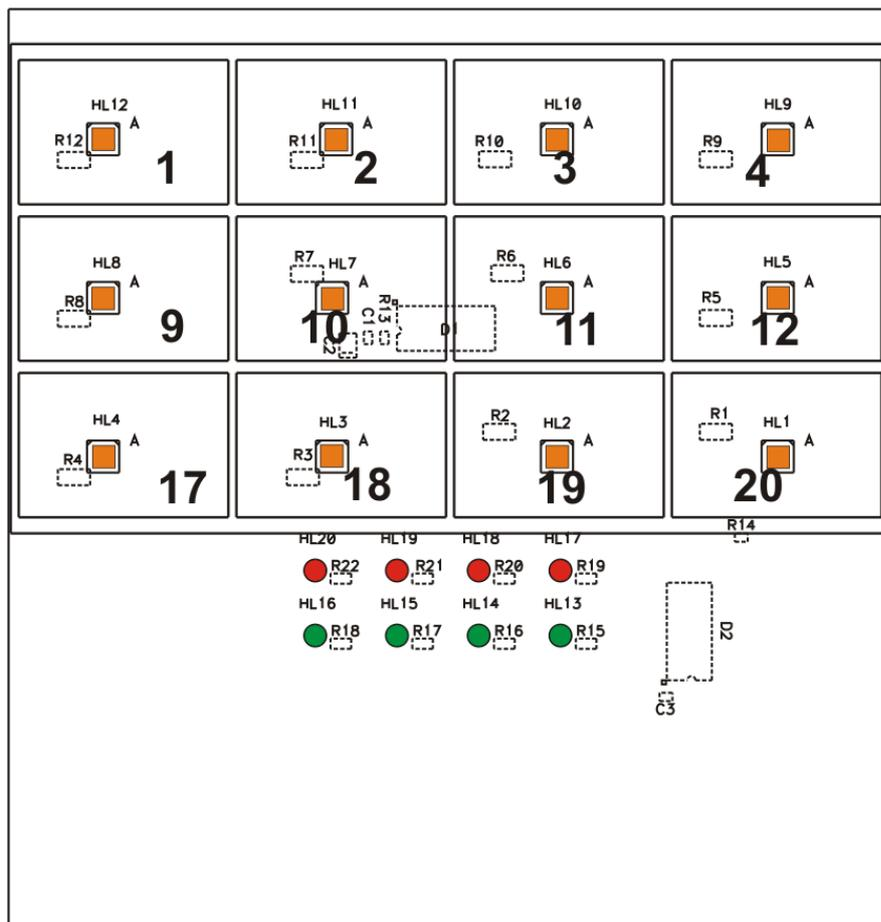
Рисунок 4.3 – Плата модуля расширения индикации МРИ1-12
