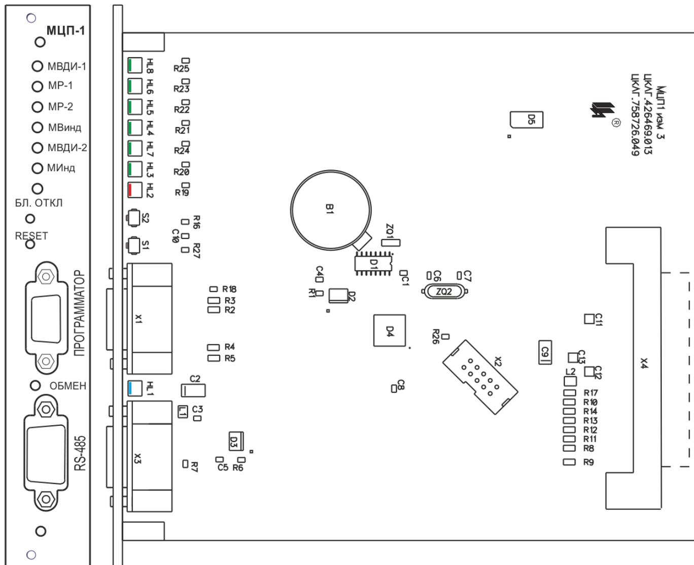
Рисунок 4.4 – Плата модуля центрального процессора МЦП-1
