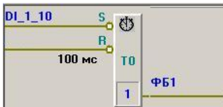
Тип 1 - «Задержка включения с запоминанием»
