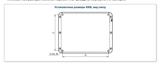
Таблица 6. Установочные размеры взрывозащищенных клеммных коробок ККВ
